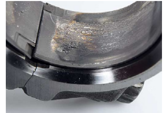
Túlhevülés miatt bekövetkezett, nagy felületű berágódás a hajtórúd alsó csapágyán, a fehérfém már beleégett az alatt lévő ólombronz támasztórétegbe.
