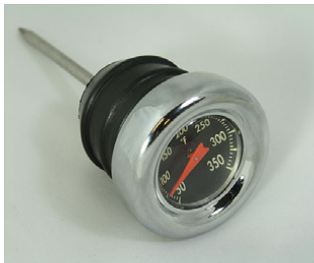
Ez a nivópálca olajhőmérsékletet is mér. Hasznos többletszolgáltatás.
