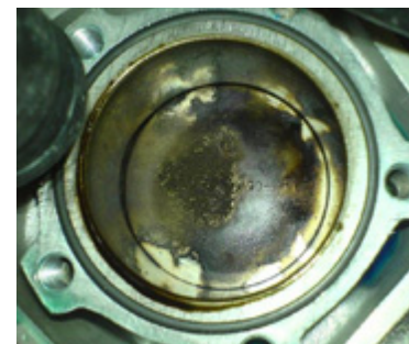
Normális, barna színű dugattyútető
