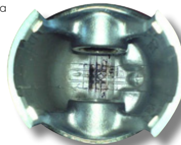
A belső oldalon látható folt a dugattyúkorona túlhevülése miatt rakódott le
