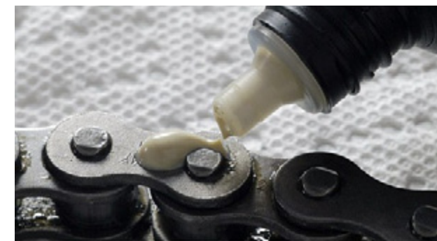
A tömítőgyűrű nélküli láncok kenőanyagai a belső kenést is megoldják, igen tapadóképesek, hogy ne centrifugálódjanak ki
