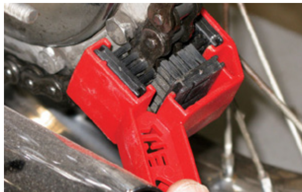
Speciális lánc tisztító kefe. Használata praktikus, de egy kiselejtezett fogkefe is megteszi
