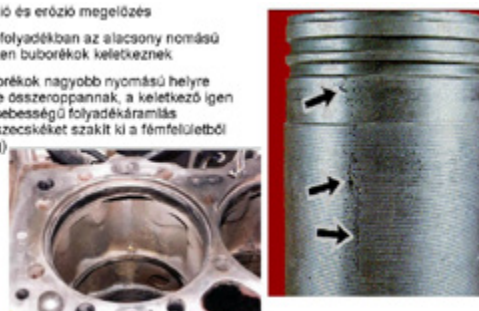
Kavitáció kialakulása a hűtőrendszerben
