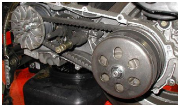
Fokozatmentes, variátoros sebességváltó. Kenőanyagot nem igényel.
