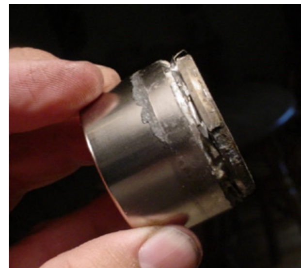
Ezt a dugattyút is a korrózió ette meg. Az időben végrehajtott fékfolyadék cserével ez megelőzhető.
