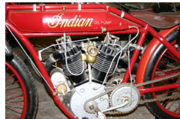
Ezen az Indian motoron jól látható a kézi olajpumpa (nyílal jelelve az üzemanyag tankon)
