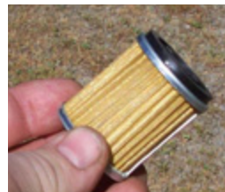
Papírbetétes olajszűrő. Gazdaságos, egyszerű megoldás.
