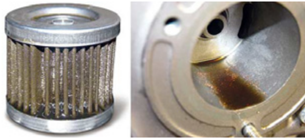
A szűrő felületén és a szűrőházban is szemmel látható méretű kopásfém részecskék figyelhetők meg. Ez már rendellenes kopásra utal.
