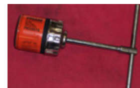
Patronos olajszűrő (a képen a leszedéséhez szükséges célszerszámmal együtt).
