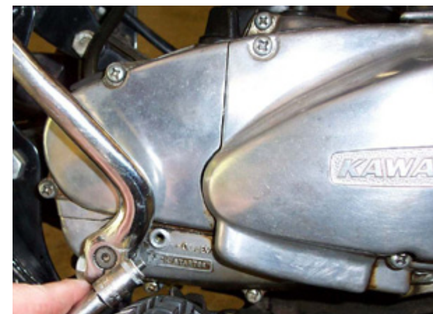
Olajsint-ellenőrző furat. A furat helyzete egyben az optimális olajsintet jelenti.
