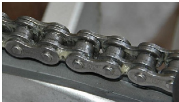
A tömítőgyűrűs láncok kenőanyagainak feladata a görgők kenése és a rozsdavédelem
