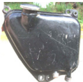
Lemzből készült olajtartály száraz karteres motorhoz
